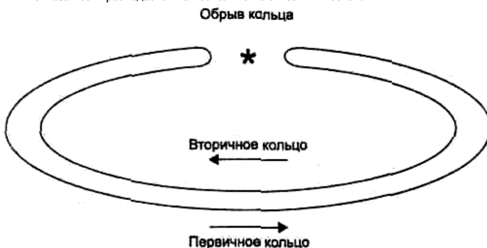
рис. Восстановление работоспособности сети FDDI при обрыве кольца.
